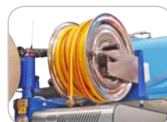
Naspo bassa pressione manuale: - 35 mt tubo 3/4"
